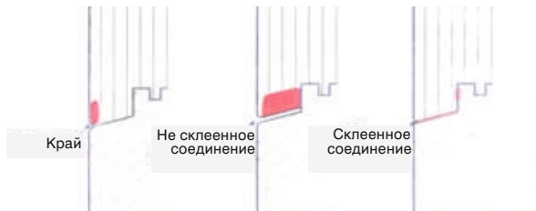
Рисунок 37 - Склеивание соединения. Правильно склеенное соединение обеспечивает долговечность и стабильность с течением времени, предотвращая попадание воды, влаги и воздуха.
